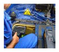
Realizamos inspecciones mediante videoscopio en interior de multiplicadoras para identificar daños en rodamientos o piñoneria emitiendo informe detallado con el resultado obtenido.
